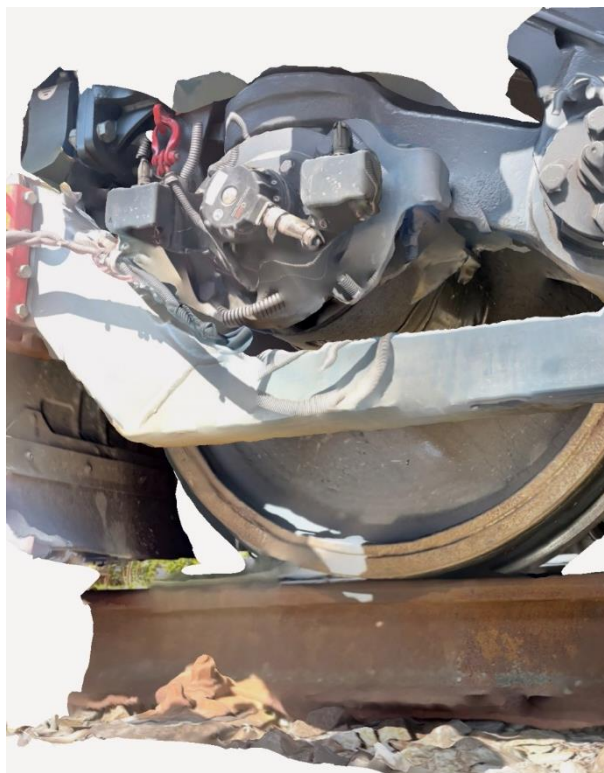
Obr. 2 – Terénní digitální 3D sken řešené části podvozku MVŽSv2 [zdroj: autoři]
