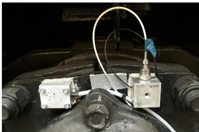
Obr. 4 – Snímače na ložiskové skříni (vyvíjený – vlevo a komerční snímač – vpravo)
