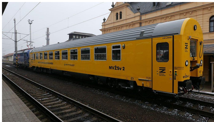
Obr. 1 – Měřicí vůz pro železniční svršek MVŽSv2 [zdroj: Správa železnic, státní organizace]
