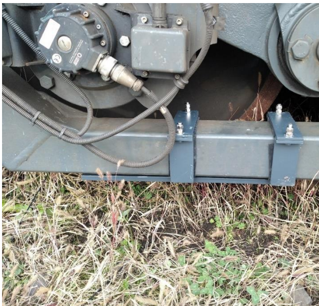
Obr. 9 – Instalace mechanické části systému HLUKOS na diagnostický vůz MVŽSv2 [zdroj: autoři]
