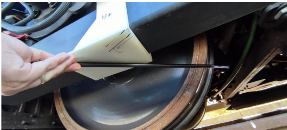
Obr. 3 – Prototypování neinvazivního kotevního přípravku vzorkem získaným 3D tiskem [zdroj: autoři]
