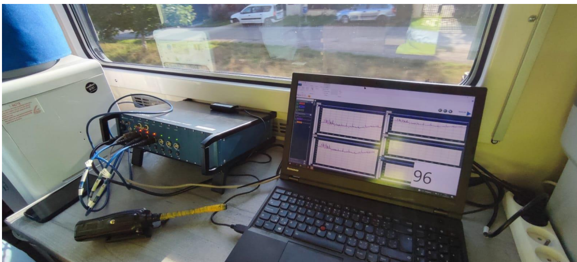
Obr. 5 – První měřicí pracoviště během zkušební jízdy pro potřeby testování s multikanálovým laboratorním analyzátozem Norsonic N850 [zdroj: autoři]
