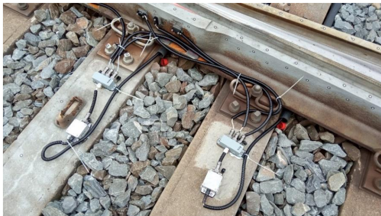
Obr. 2 – Snímače uspořádané v oblasti srdcovky
