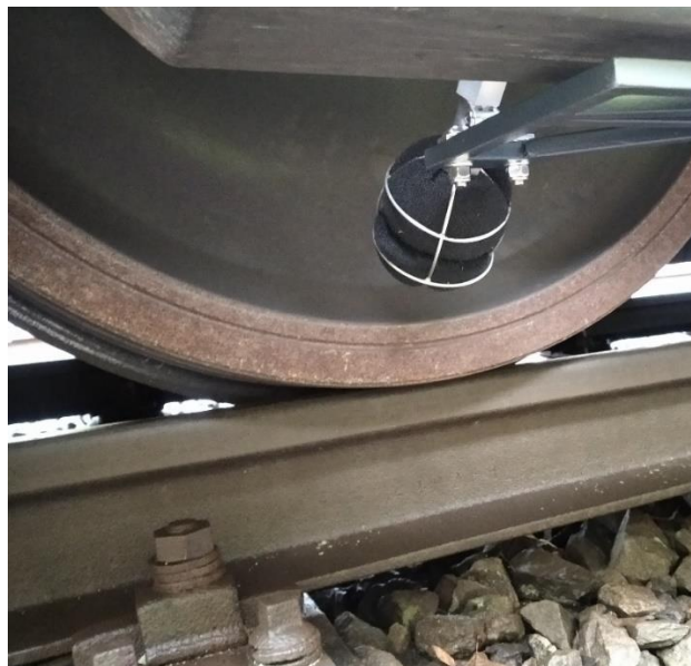
Obr. 10 – Instalace mechanické části systému HLUKOS na diagnostický vůz MVŽSv2 – detail [zdroj: autoři]
